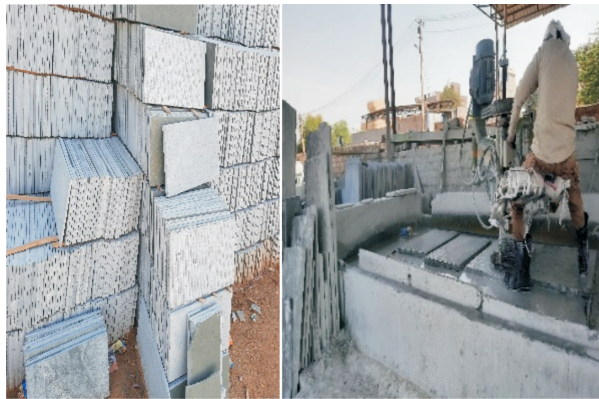
Fig. 2. (a) Kota stone (b) dressing of stone
